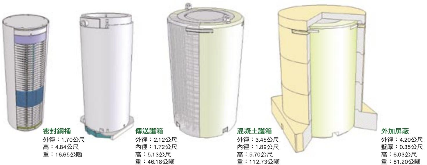
核一廠用過核燃料是以乾式儲存系統層層防護（上方為示意圖），可儲存56束燃料。
